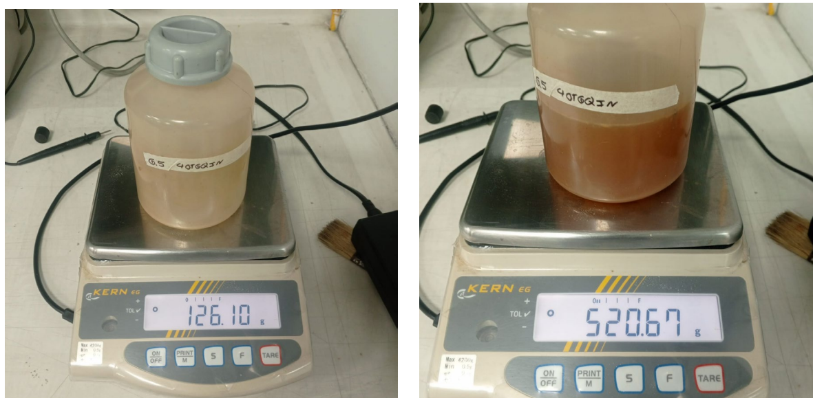
Figura 2. Registro fotográfico del pesaje para el balance de masa de la biomasa en la etapa de centrifugación.
